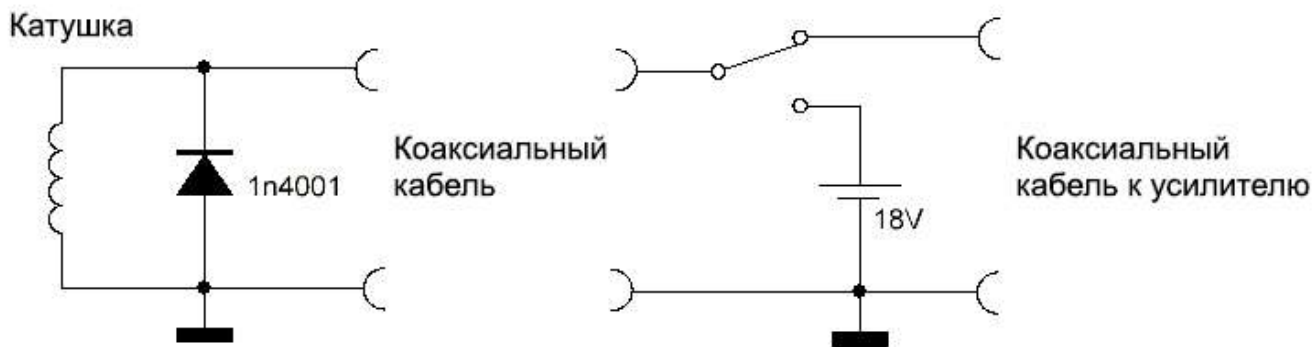
Схема подключения катушки к диоду, переключателю поляризации и усилителю.
