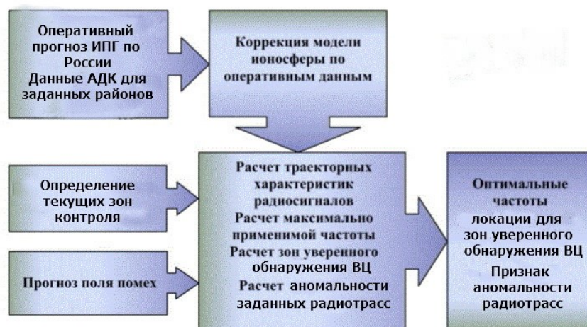
Рис. 8: Структурная схема проведения точного прогноза характеристик радиотрасс на основе гелиогеофизических данных
